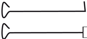
Pic.5 Czyszczaki kotła.
