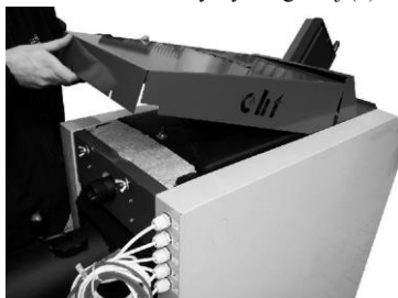
Demontaż wyczystki górnej (2)
